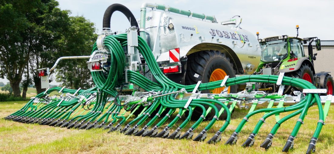
HYDRAULISCHES EINKLAPPEN • BASIC: einfach (3-teilig) • START: doppelt (5-teilig)
